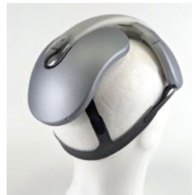
**Hinweis:** Verwenden Sie die Gurte nur bei Bedarf und achten Sie darauf, dass der Druck der Elektroden auf die Kopfhaut nicht zu hoch ist, da dies aufgrund des erhöhten Drucks auf die Blutgefäße und Nerven am Kopf zu Unbehagen und leichten Kopfschmerzen führen kann. Das niostem-Headset wurde so konzipiert, dass es bequem zu tragen ist, d.h. kein übermäßiger Druck erforderlich ist.
