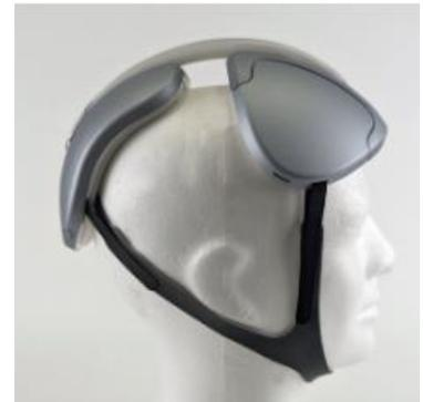
**B. Langer Sicherheitsgurt:** auch bekannt als Kinngurt (unten). Dieses Band sorgt für mehr Sicherheit und einen besseren Kontakt zwischen Kopfhaut und Elektroden bei Personen mit langem/dickem Haar. Es ermöglicht dem Benutzer auch die Durchführung intensiverer Aktivitäten.
